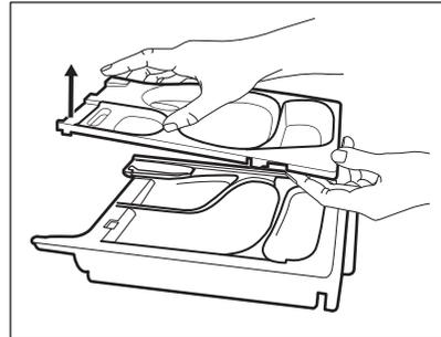
4. Wasche die Waschmittelschublade und jeden Einsatz unter fließendem Wasser.
