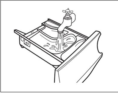
5. Stellen Sie sicher, dass alle Waschmittelreste an der Ober- und Unterseite der Aufnahme entfernt wurden. Reinigen Sie die Schubladenaufnahme mit einer kleinen Bürste.
