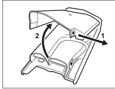
7. Stellen Sie sicher, dass alle Waschmittelrückstände aus dem Einspülkasten entfernt wurden. Verwende nur weiche, feuchte Tücher.
