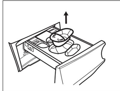
3. Hebe die obere Abdeckung der Fächer an, um sie zu entfernen.
